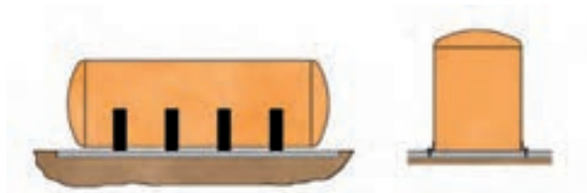
CISTERNA HORIZONTAL Y VERTICAL, RESPECTIVAMENTE, COLOCADAS ENCIMA LA LOSA DE HORMIGÓN
